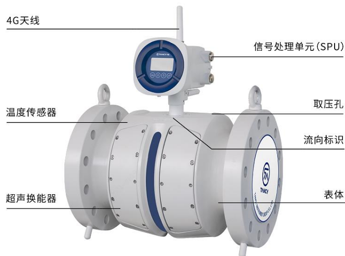
图 3 流量计结构图
